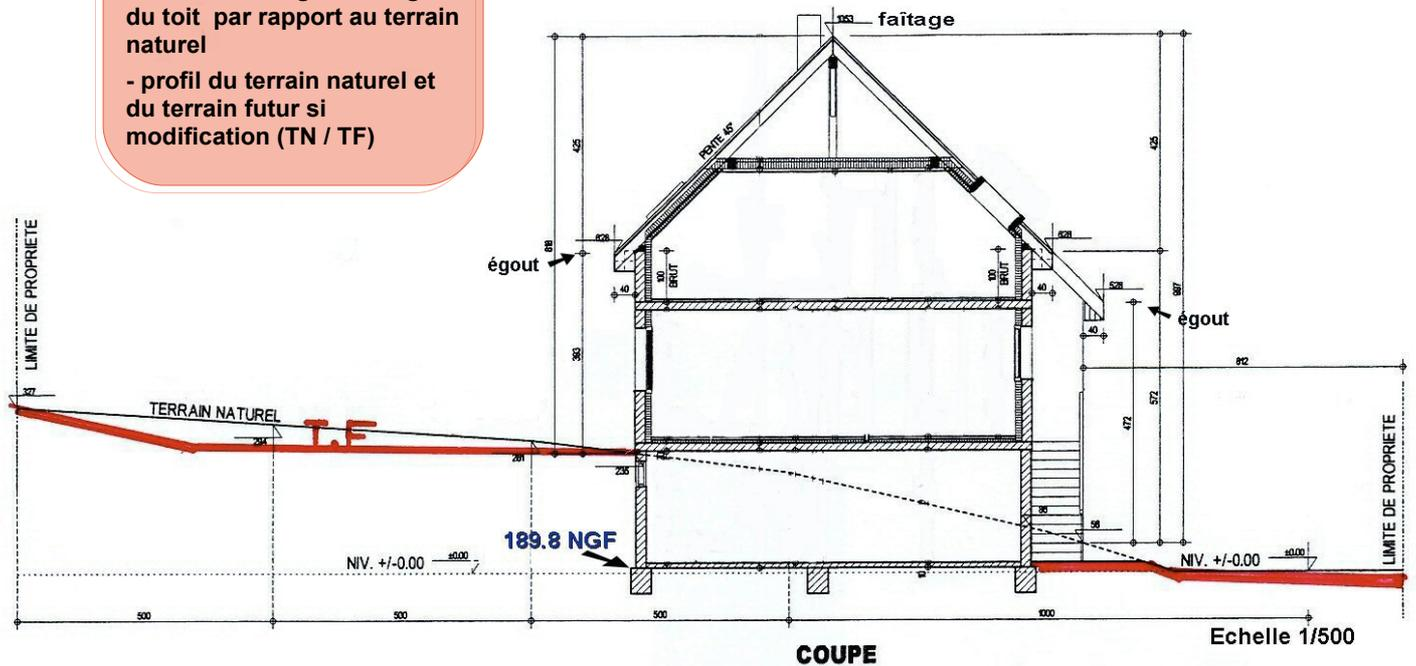
**Nota :** en zone PPR<sup>1</sup>, indication nécessaire de la cote NGF<sup>2</sup> au niveau du plancher inférieur
